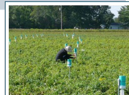
Installer des pluviomètres ou des récipients à des endroits stratégiques du champ pour mesurer la profondeur réelle (et le volume) d'eau fournie à la culture et son uniformité.
